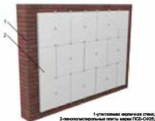
Рисунок 4. Дюбелирование на рядовом участке стены
